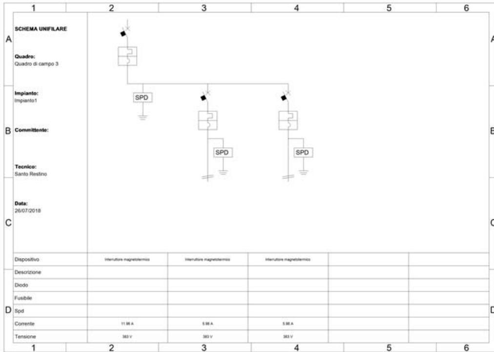
Fig. 9: Schema unifilare quadro "Quadro di campo 3"
