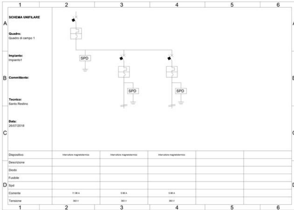
Fig. 7: Schema unifilare quadro "Quadro di campo 1"
