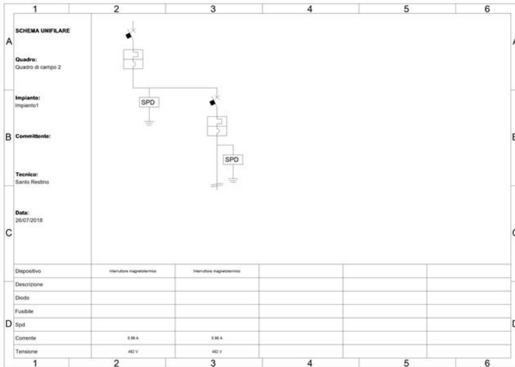
Fig. 8: Schema unifilare quadro "Quadro di campo 2"
