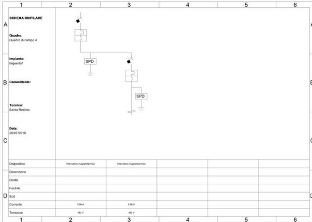
Fig. 10: Schema unifilare quadro "Quadro di campo 4"
