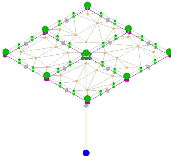
Dalle illustrazioni precedenti si evince come le aste, sia travi che pilastri, siano schematizzate con un tratto flessibile centrale e da due tratti (braccetti) rigidi alle estremità. I nodi vengono posizionati sull'asse verticale dei pilastri, in corrispondenza dell'estradosso della trave più alta che in esso si collega. Tramite i braccetti i tratti flessibili sono quindi collegati ad esso.
